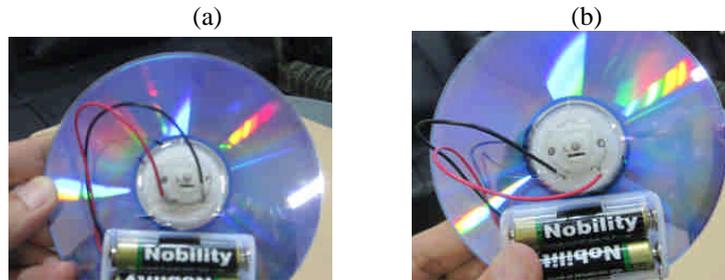
圖 6 風扇旋轉方向改變之接線圖，其中(a)、(b)分別為風扇逆時針與順時針旋轉的接線方式。
